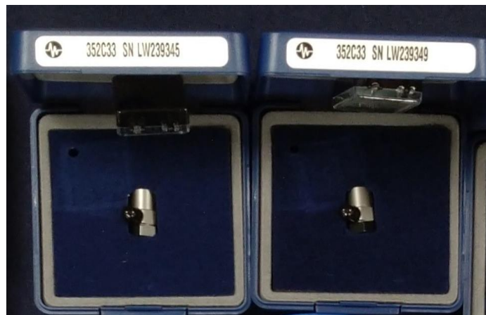
Uniaxial accelerometers (2 Nos.)
