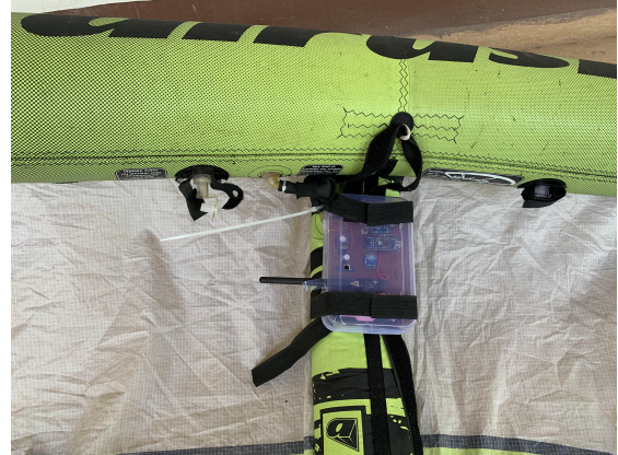
(d) Kite transmitter mounted on the kite
